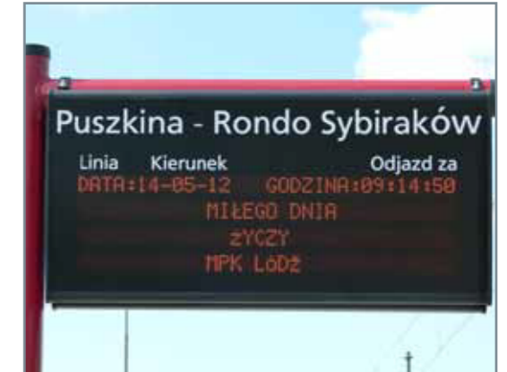
Wyświetlacz 4-wierszowy, dwustronny, rozdzielczość 192x8 pikseli/wiersz, rozstaw pikseli 6 mm, komunikacja Ethernet, wstępnie nagrany dźwięk, sitodruk
