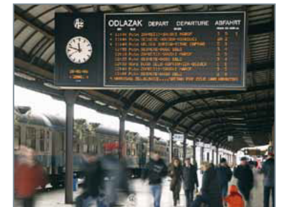
Wyświetlacz 10-wierszowy, jednostronny, rozdzielczość 288x8 pikseli/wiersz, rozstaw pikseli 8 mm, komunikacja Ethernet, zegar analogowy
