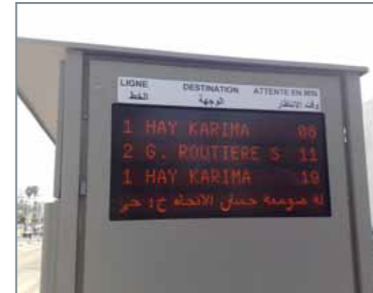
Wyświetlacz 4-wierszowy, jednostronny, rozdzielczość 192x16 pikseli/wiersz, rozstaw pikseli 4 mm, komunikacja Ethernet
