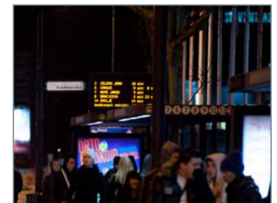
Wyświetlacz 2- i 6-wierszowy, jednostronny, rozdzielczość 192x8 pikseli/wiersz, rozstaw pikseli 4 i 6 mm, łączność Ethernet/GPRS/Zigbee
