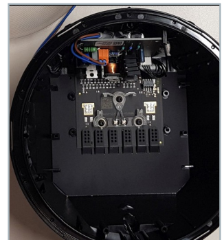
Źródło światła Futurled6-200mm zainstalowane w obudowie
